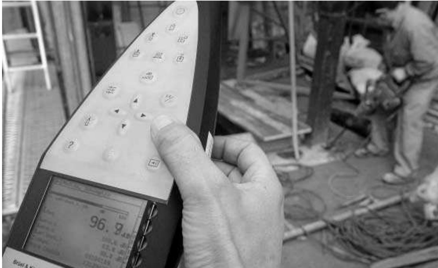
Un técnico realiza una medición de ruido en una obra.
